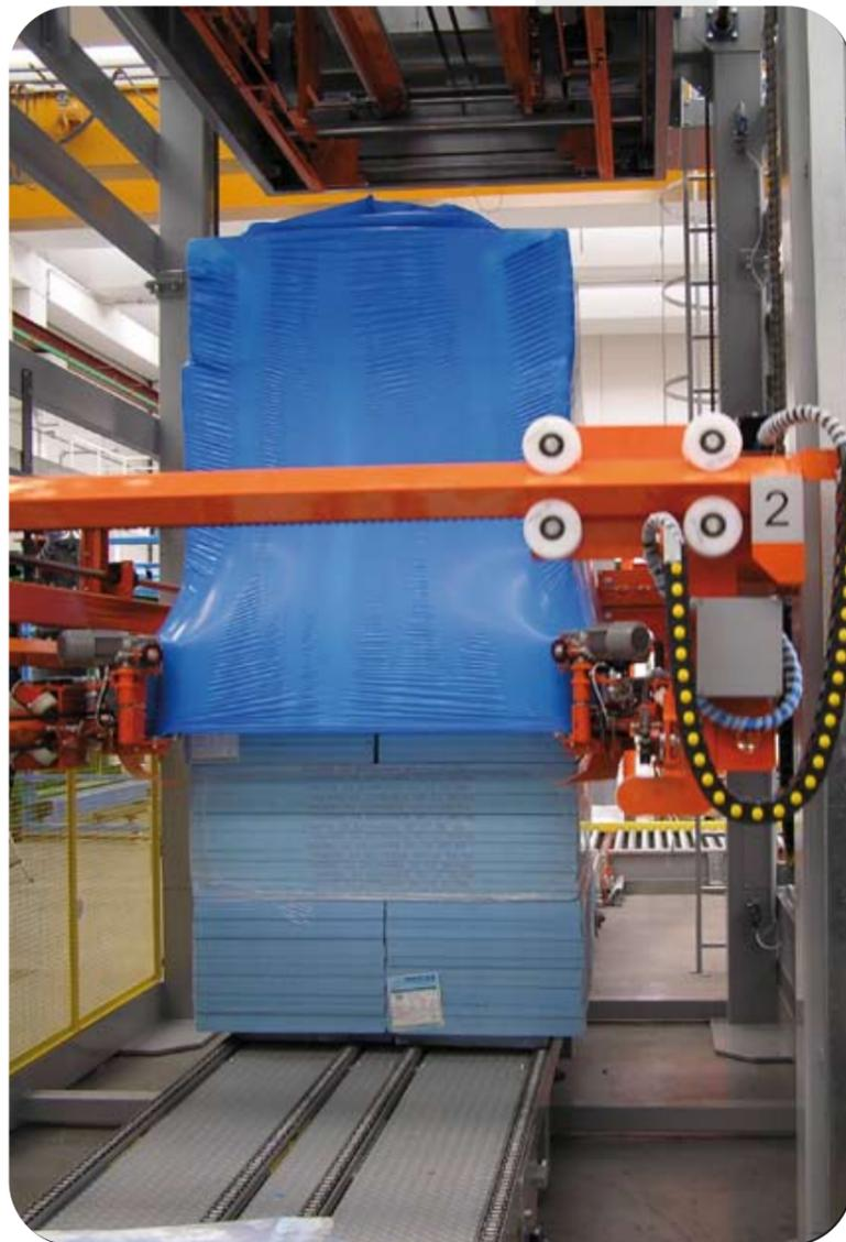
L'incappucciante BOCEDI è in grado di creare un cappuccio elastico su misura del pallet e di confezionarlo ermeticamente, sfruttando le caratteristiche di resistenza ed elasticità del materiale stretch hood (film plastico coestruso fornito sottoforma di bobine tubolari).
