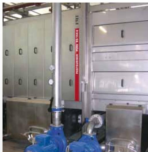
Pour atteindre l'échange thermique nécessaire, pour modifier les plages des températures du produit, on utilise de l'eau qui est pulvérisée sur les bouteilles ou les boîtes à différentes températures pour les diverses zones de traitement le long du tunnel.
