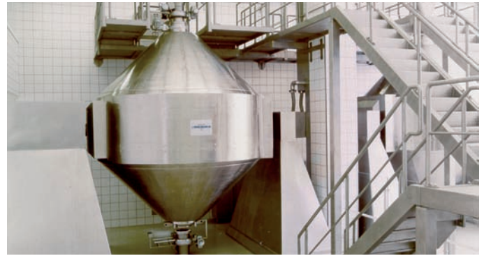
Mischanlage mit CIP-Reinigung Mixing Plant with CIP System
