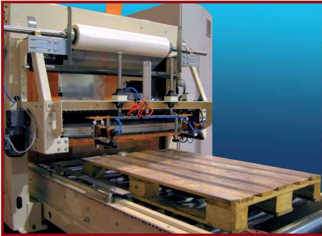
Dispositivo mettfoglio in plastica su pallet vuoto Plastic film dispenser on empty pallet
