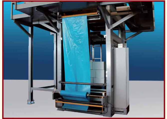
Dispositivo mettfoglio in plastica su pallet vuoto e fra gli strati Plastic film dispenser on empty pallet and interlayers
