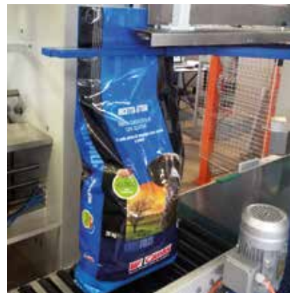
Bracci traslatori guida-sacchi Bag transferring arms
