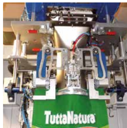
Bocca-sacco per sacchi a soffiutto Side gusseted bag filling spout
