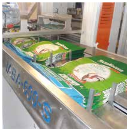
Magazzino sacchi a tre posizioni con sfogliatore rotativo Three stacks empty bag magazine with rotating destacker
