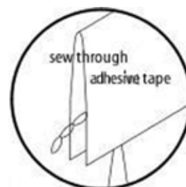
Applicazione di un cavalotto di carta adesiva sulla cucitura
