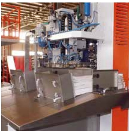
Magazzino sacchi a due posizioni Two stacks empty bag magazine
