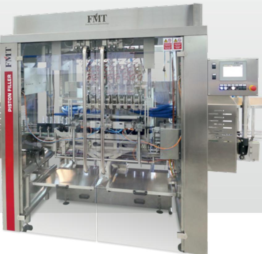
**Machines indiquées pour le remplissage de recipients en verre, en metal ou en plastique avec de produits denses ou semi-denses, pâteux, liquides, homogènes ou avec des morceaux, pulpes ou fibres. La gamme de produits pouvant être remplis comprend également: concentré de tomate, confitures, mayonnaise, ketchup, sauces, patés, huiles alimentaires, crèmes, baby-food, miel, yaourt etc.**
