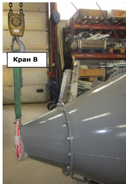
Рис. 3: Пример подъемной петли в основании фильтра.
