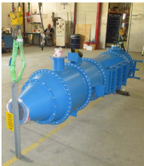
Рис. 3: Пример опоры, прикрепленной к дну фильтра (здесь используется как подъёмная петля).
