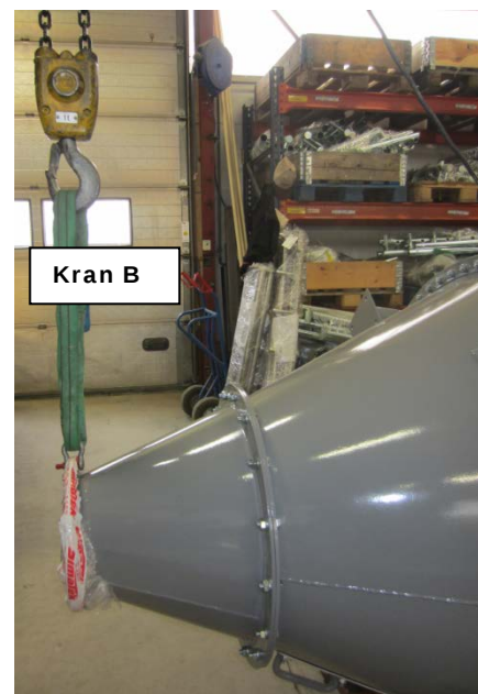
Fig. 2: Eksempel på anhugningspunkt i bund af filter.
