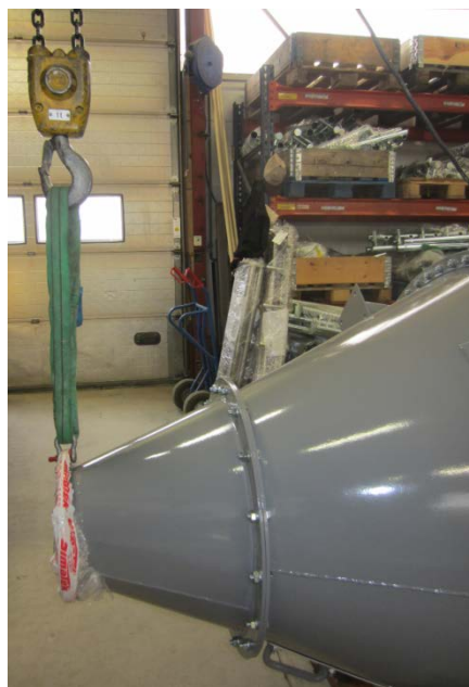
Рис. 2: Пример подъёмной петли в основании фильтра.
