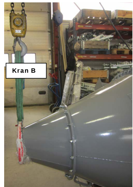
Abb. 2: Beispiel für einen Anschlagpunkt am Boden des Filters.
