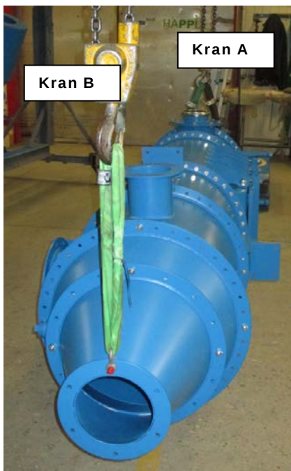
Abb. 3: Aufrichten des Filters – zum weiteren vertikalen Transportieren.
