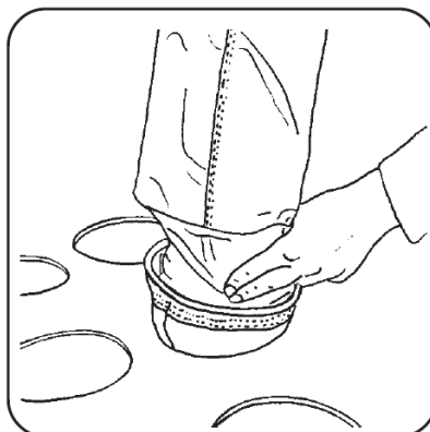
Fig. 1. Montagekraven monteres i hullet, hvorefter posen føres igennem montagekraven. Først når posen er kommet helt ned, fjernes montagekraven.
