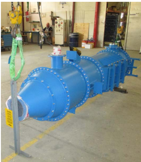
Abb. 3: Beispiel für Abstützung am Boden des Filters, der hier als Anschlagpunkt verwendet wird.
