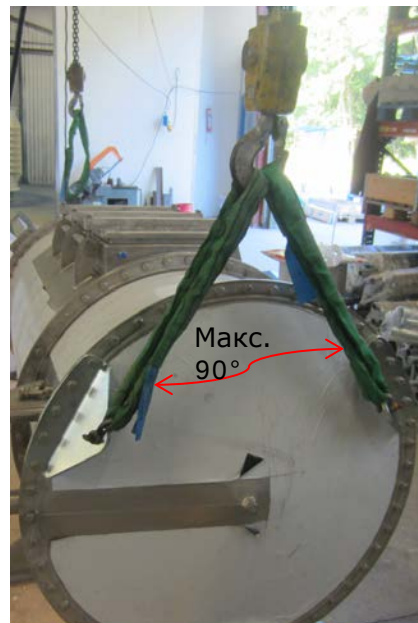
Рис. 1: Подъёмные скобы сверху фильтра. Здесь используются две скобы.
