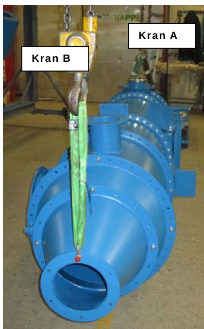
Fig. 3: Rejsning af filter – som fortsættes i et vertikalt løft. Kran A: 2 stropper, anbragt i henhold til fig. 1. Kran B: Langsomt lades filteret nå vertikal position.
