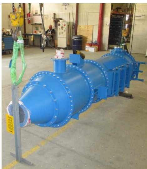
Fig. 3: Eksempel på understøtning i bunden af filteret, der her anvendes som anhugningspunkt.
